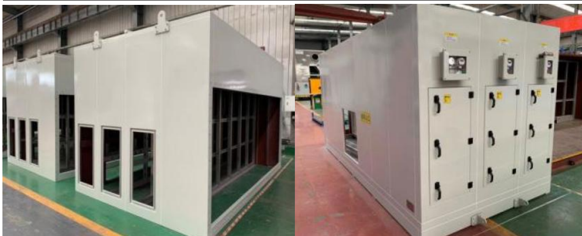
图 6.2.2-4 多级漆雾过滤系统
